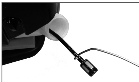
Рис. 6 Обслуживание топливного фильтра
